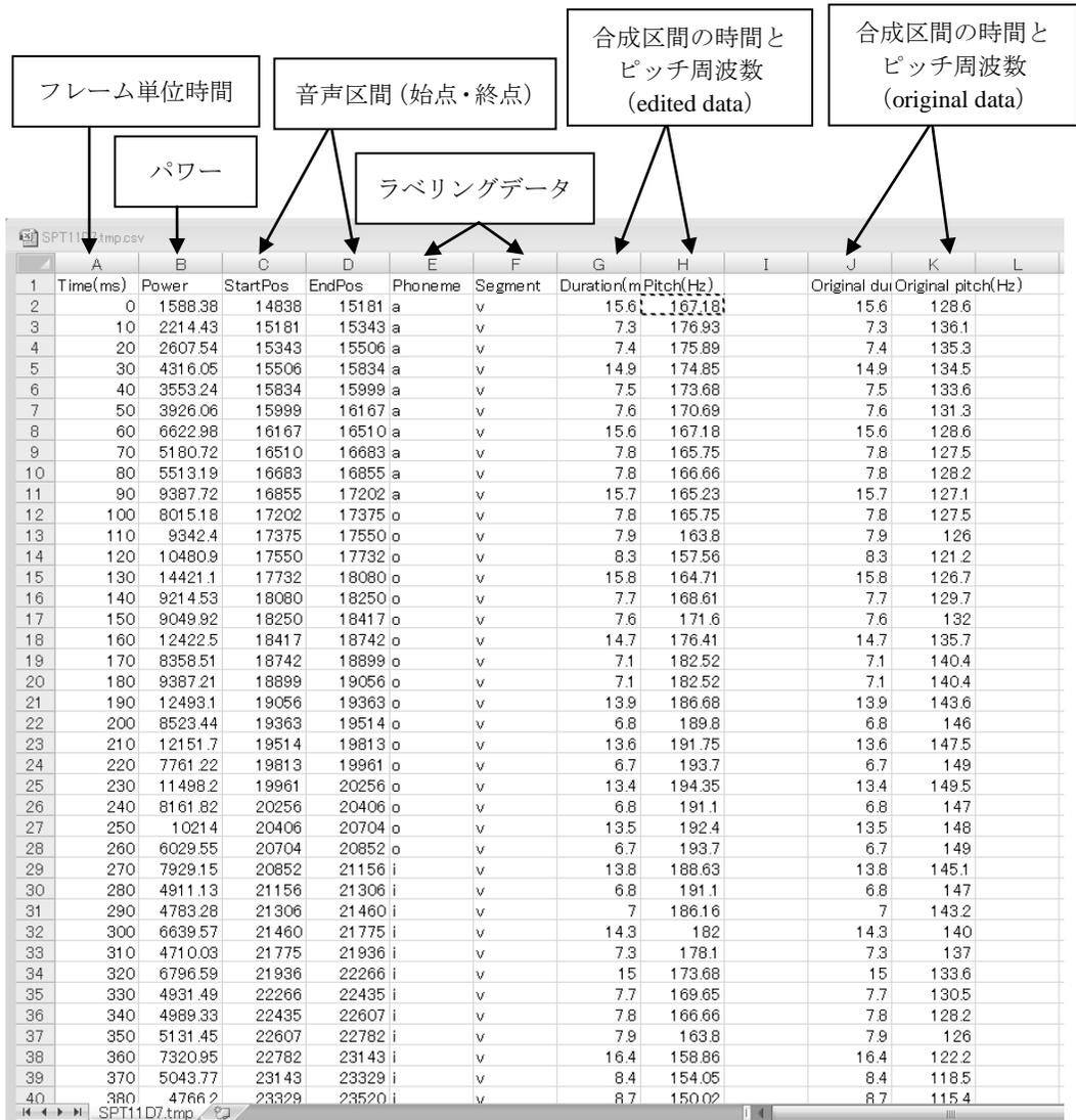
図9 エクセル表による音声パラメータの表示と変更
